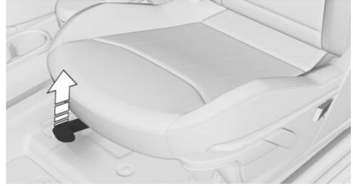
Чтобы отрегулировать продольное направление, потяните рычаг регулировки продольного направления спереди на сиденье вверх и переместите сиденье в нужном направлении.
