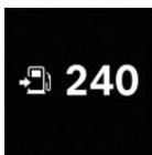
Текущий запас хода в виде числового значения отображается рядом с индикатором уровня топлива.
