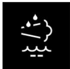
При опорожнении бака SCR отображается контрольная лампа. Немедленно долейте минимум 10 литров восстановителя. Двигатель продолжает работать до выключения и при условии соблюдения всех
