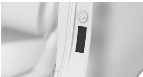
Значения давления воздуха в шинах указаны в табличке на стойке двери водителя.
