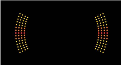
Загорающиеся последовательно желтым поля указывают на предстоящий момент переключения передач.
