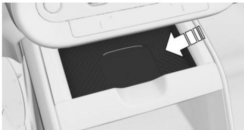
1. Чтобы включить режим готовности к движению с помощью MINI Digital Key, положите смартфон в центр лотка в центральной консоли.
