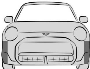
Радарные датчики находятся сбоку в переднем бампере.
