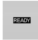
Индикатор READY на центральном дисплее сигнализирует, что автоматическая функция «Старт/стоп» готова к автоматическому пуску двигателя.
