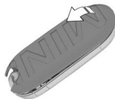
3. Откройте крышку отсека аккумуляторной батареи, повернув ее против часовой стрелки с помощью монеты.
