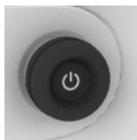
Для ручного перехода в состояние покоя удерживайте регулятор громкости в коммутационном центре нажатым до тех пор, пока не погаснут все индикаторы.
