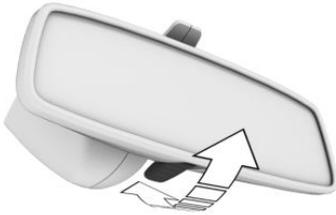
Для уменьшения слепящего действия салонного зеркала поверните рычаг на салонном зеркале с ручным затемнением вперед.
