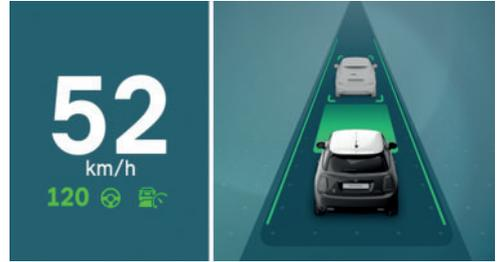
Пример с активной системой помощи водителю: отображаются контрольные и сигнальные лампы для системы контроля дистанции и режима Assisted Driving Mode. Одновременно система контроля дистанции в анимированном виде отображается в Assisted View.
