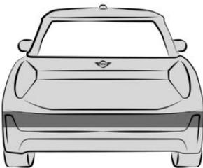
Ультразвуковые датчики систем парковки находятся в заднем бампере.
