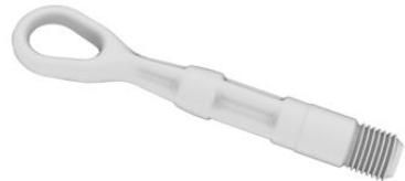
Всегда возите с собой привинчиваемую буксировочную проушину.
