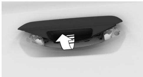
3. Положение интегрированного ключа в дверном замке зависит от автомобиля.
