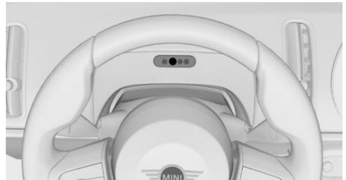
Один источник инфракрасного света находится в приборной панели. В зависимости от условий освещенности, этот источник света видно после включения режима готовности автомобиля к эксплуатации.
