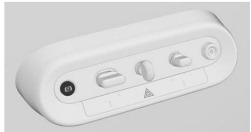
**(P)** Чтобы включить положение рычага селектора P и электромеханический парковочный тормоз, нажмите клавишу стояночного тормоза в коммутационном центре.
