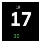
Настроенная скорость системы регулирования скорости отображается под показаниями спидометра. Цвет обозначает состояние системы.
