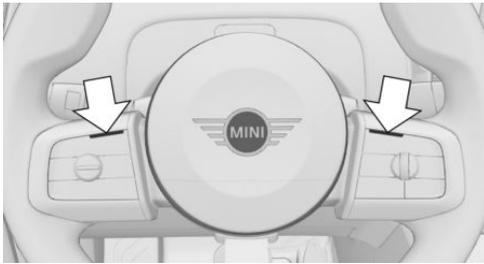
В зависимости от ситуации горят оба светодиода над блоком клавиш на рулевом колесе.
