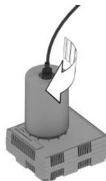
4. Открутите колпачок вентиля с колеса и прикрутите соединительный элемент наполнительного шланга к вентилю.
