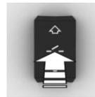
Чтобы поднять или закрыть стеклянный люк, коротко нажмите выключатель стеклянного люка в потолке вверх.
