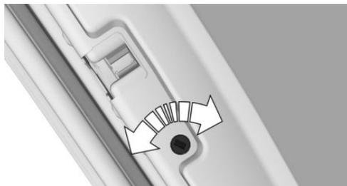
Чтобы заблокировать двери в задней части салона, с помощью интегрированного ключа разблокируйте или заблокируйте защитный выключатель на задней двери.
