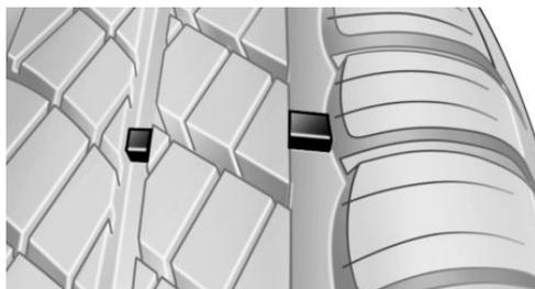
По окружности покрышки распределены установленные производителем шин индикаторы износа высотой не менее 1,6 мм, которые служат индикатором износа рисунка протектора.
