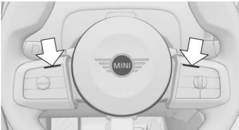
По аналогии с индикаторами режима Assisted Driving Mode на центральном дисплее горят оба светодиода над блоками клавиш на рулевом колесе.
