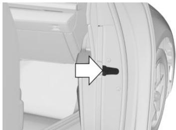
Боковой дверной замок для ручной блокировки дверей.
