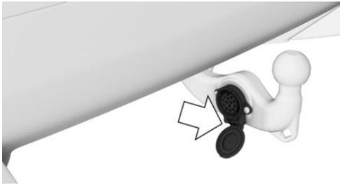
Розетка подключения электрооборудования прицепа находится на тягово-сцепном устройстве.
