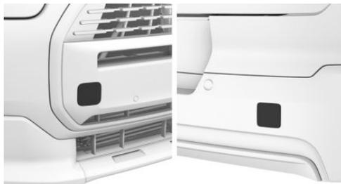
Резьба для буксировочной петли находится за кожухом на переднем и заднем бамперах.
