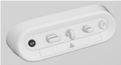
**(P)** Чтобы включить положение рычага селектора P и электромеханический парковочный тормоз, нажмите клавишу стояночного тормоза в коммутационном центре.
