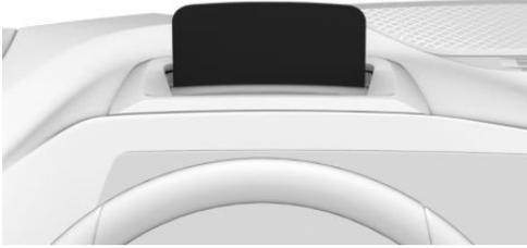
Проекционный дисплей включен.
