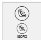
При наличии такого символа автомобиль имеет допуск в соответствии со стандартом ISOFIX. Этот значок обозначает места установки нижних креплений системы. Нижние фиксаторы соответствуют требованиям ISOFIX.
