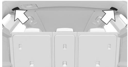
3. Вставьте оба верхних крепежных штифта разделительной сетки багажника в соответствующие крепления,
