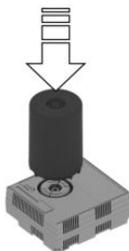
2. Поверните емкость с герметиком для шин до упора на 90° по часовой стрелке.
