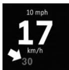
Установленная скорость системы регулирования скорости отображается под показаниями спидометра серым цветом.
