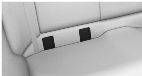
Крепления для нижних фиксаторов находятся на задних сиденьях под обозначенными кожухами. Чтобы освободить фиксаторы, откройте крышки движением вверх.
