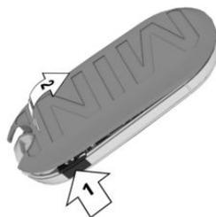
2. Вытяните кожух из верхней защелки, стрелка, и снимите кожух.
